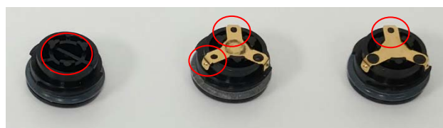
Skadade batterilock: Använd EJ när det finns färre än 3 upphöjda punkter eller om metallkontakten saknas helt.
