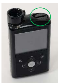
Batterilocket finns på toppen av pumpen där AA-batterifacket är placerat.
