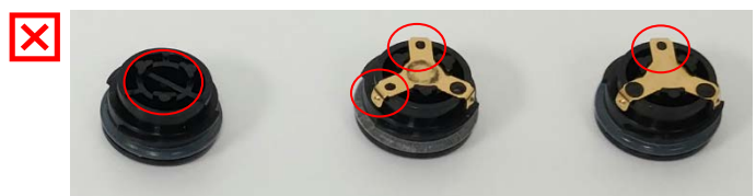
Skadade batterilock: Använd EJ när det finns färre än 3 upphöjda punkter eller om metallkontakten saknas helt.
