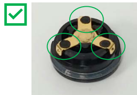
Oskadat batterilock - Fortsätt att använda. Har tre upphöjda, runda, svarta plastprickar som håller metallkontakten på plats.
