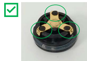
Vahingoittumaton paristolokeron kansi – käyttöä voi jatkaa. Kannessa on kolme kohotettua, pyöreää, mustaa pistettä, jotka pitävät metallikoskettimen paikallaan.
