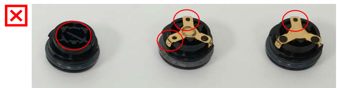
Vahingoittunut paristolokeron kansi – älä käytä. Metallikosketin puuttuu tai näet alle 3 kohotettua muovipistettä.
